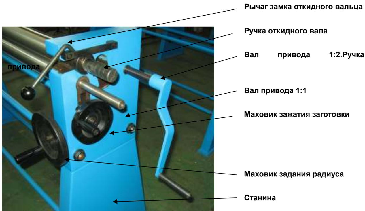
Машина предназначена для изготовления желобов и труб из листового материала, имеет два приводных вала, один из которых откидной, для легкого снятия готовых изделий. Откидной вал оснащен замком для предотвращения его самопроизвольного раскрытия в процессе работы. Слева, под защитным кожухом находится шестеренный механизм привода валов. Машина имеет две рабочие скорости, в зависимости от того, куда установлена ручка привода валов (см. рис.)
