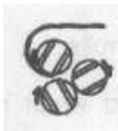
7. ДЛЯ СНЯТИЯ ГОТОВОГО ИЗДЕЛИЯ – открыть замок откидного вальца, подняв ручку и повернув рычаг. Откинуть вал, снять деталь. При недостаточной длине материала или ненадлежащем диаметре изделия, необходимо изготовить дополнительные образцы. При надлежащей регулировке вальцов можно легко изготовить партию идентичных изделий.
